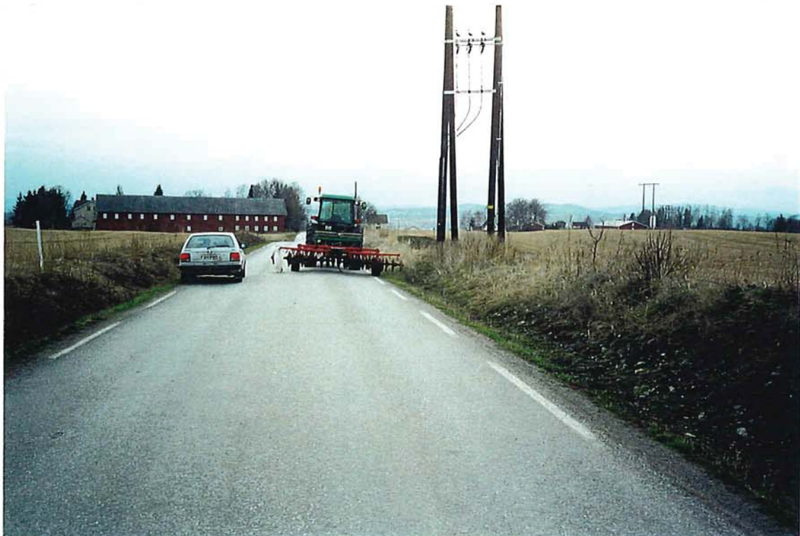
Figur 3.4: Selv om traktor og redskap legges godt ut på siden av fylkesveien, vil plassen til forbikjøring ofte bli liten. Ved bruk av autovern helt inntil veikanten kan maskinen ikke legges utover mot grøften.
