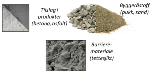
Figur 1 Fraksjoner fra sikting og vasking av forurenset masse kan nyttiggjøres til ulike formål
