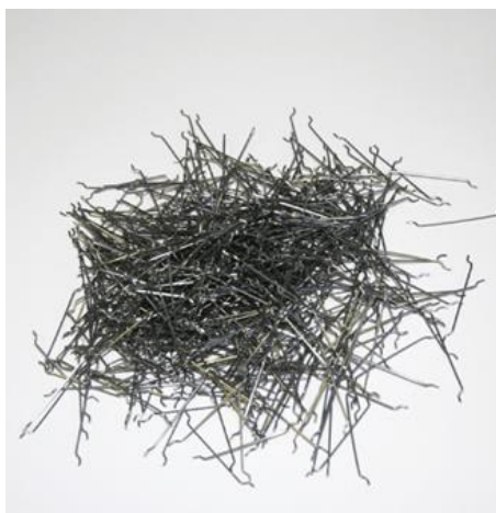
Figur 6 Stålfiber benyttet for armering av sprøytebetong kan potensielt forekomme i bunnrensk (venstre: stålfiber fra mapei.com, høyre: stålfiber som stikker ut av sprøytebetongen i en tunnelvegg).
