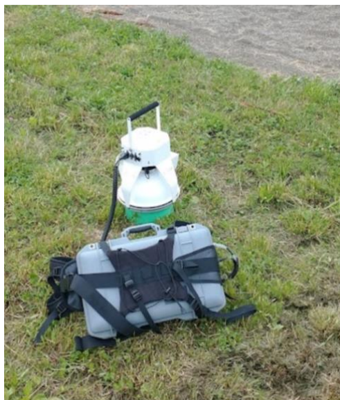
Figur 3: Flukskammer (i hvit) og gassanalysator (grå) brukt til å måle metan og \text{CO}_2 -emisjon fra overflaten av Brånåsdalen nedlagte avfallsdeponi.
